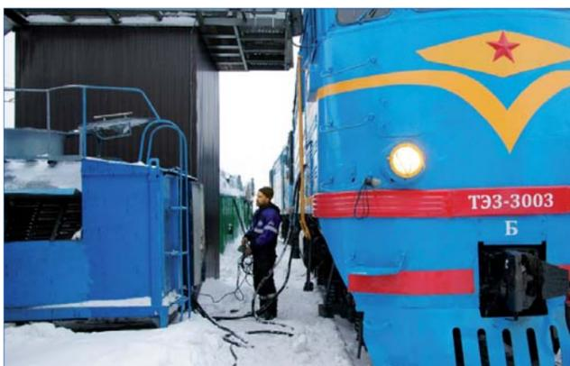
Реостатная установка для испытания тепловозов после ремонта, разработана силами локомотивного депо, рационализатор – Бокарев Виктор Арсентьевич, слесарь 6 разряда
