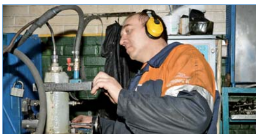
В топливном цехе локомотивного депо: Ю.Н. Касицин, слесарь по ремонту тепловозов, производит обкатку и регулировку топливного насоса высокого давления дизеля тепловоза
