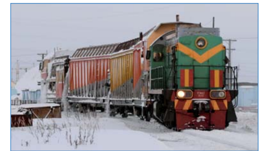
Снегоборочная машина (СМ № 1169) на ст. Коротчаево после ремонта
