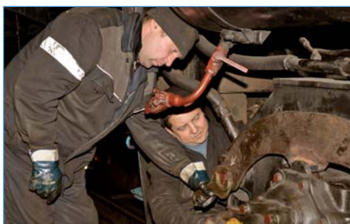
В цехе ремонта локомотивного депо: слесари по ремонту тепловозов (слева направо) В.В. Стрелков и Е.А. Иванов производят ремонт ходовой части тепловоза
